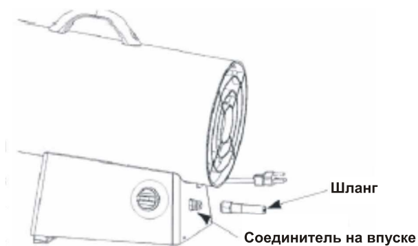
Рис 4. Подключение шланга к выпуску тепловой пушки
