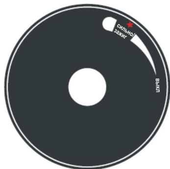
Рис 3. Обозначение положений газового вентиля тепловой пушки
